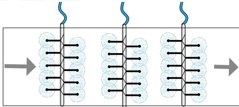
L'acqua viene distribuita e nebulizzata, tramite gli ugelli spruzzatori, su di una ampia superficie della terra. In questo modo la sabbia viene ottimamente raffreddata, viene incrementato il livello di umidità e si previene la creazione di polveri. Questo trattamento riduce, inoltre, la formazione di grumi nella terra.
